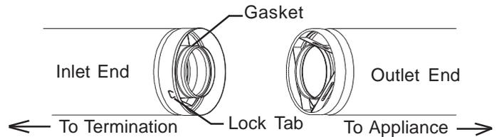
**FIG. 2 JOINT CONNECTION**
